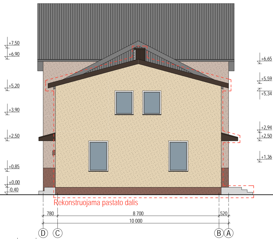
FASADAS TARP AŠIŲ D-A M 1:100
