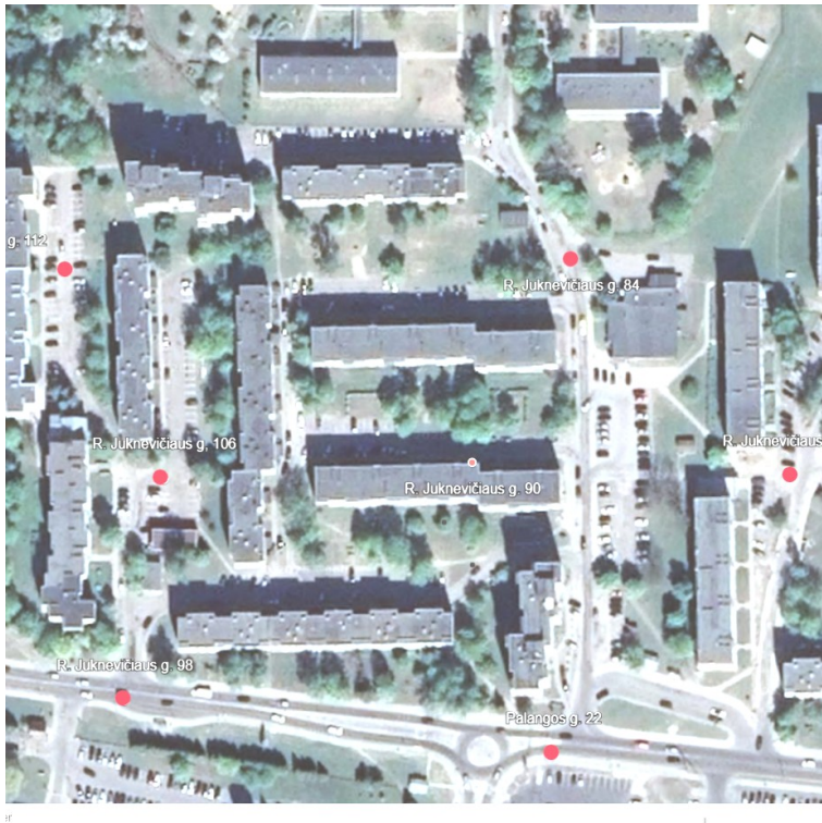
7 pav. Gaisrinių hidrantų schema.
