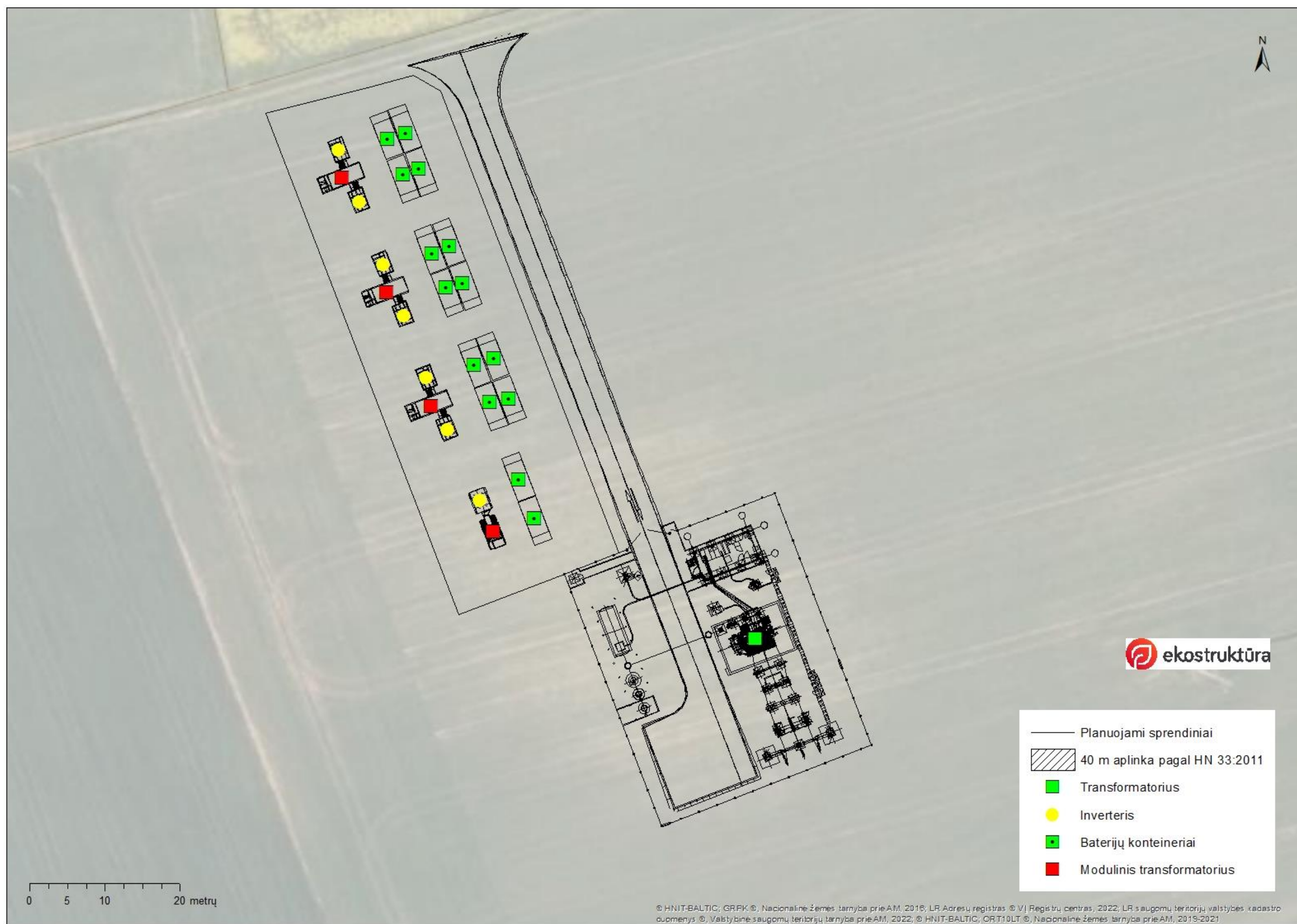
2. pav. Planuojamų sprendinių (įrenginių) išdėstymas (detalizacija)
